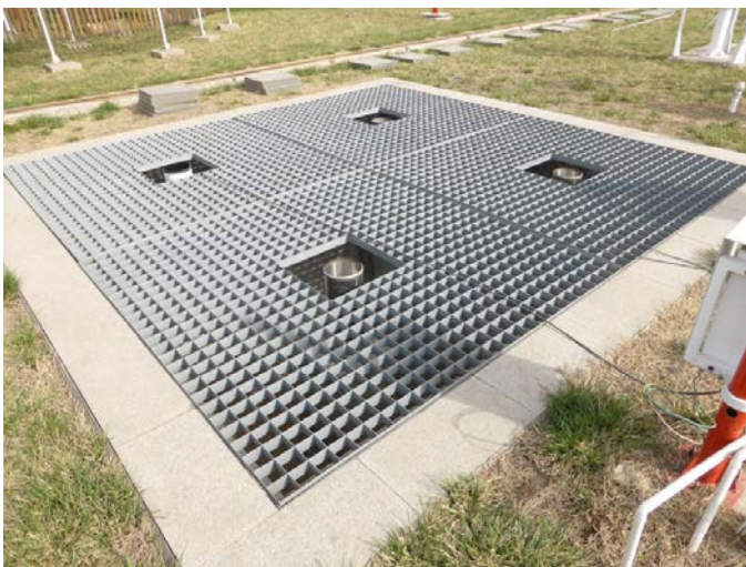
Abb. 3: Vier Messgeräte für die bodengleiche Niederschlagsmessung (Foto: Thomas Einfalt)
