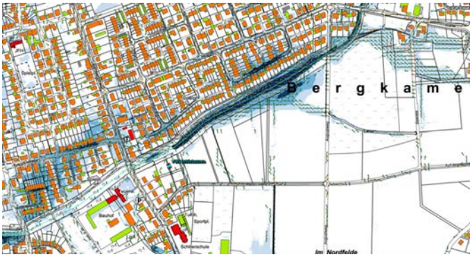
Abb. 11: Oberlauf des Kubachs in Bergkamen, Starkregen-Simulation T_n = 100 a
