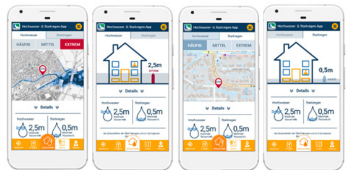
Abb. 5: App FloodCheck mit den Hochwasser- und Starkregengefahrenkarten und der Angabe der jeweiligen Wassertiefen am Haus
