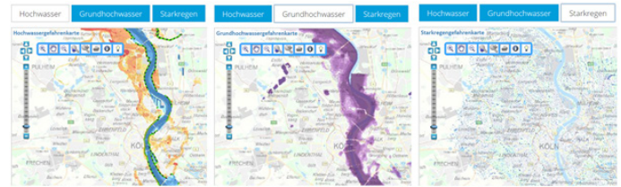
Abb. 4: Darstellung der Überflutungsgefahren Flusshochwasser, Grundhochwasser und Starkregen für Köln im Internet
