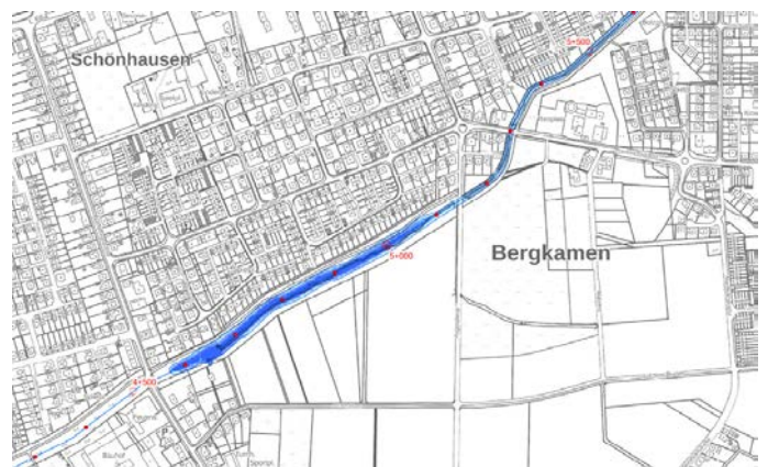
Abb. 10: Oberlauf des Kuhbachs in Bergkamen, Hochwassergefahrenkarte für HQ100
